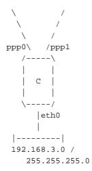
Es gibt drei Router: A, B und C. Jeder ist für ein Ethernet Segment mit einem Klasse C IP Netzwerk (Netmask 255.255.255.0) zuständig. Darüberhinaus verfügt jeder Router über jeweils eine PPP-Verbindung zu jedem der anderen beiden Router; diese bilden also ein Dreieck.
